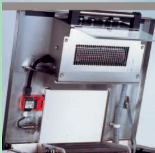
Нагревающая система установлена в крышке.
